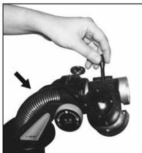
Die Erzeugung der Rotation erfolgt beim Robo-Pro Genius über die Regulierung des oberen und unteren Laufrades sowie der Ausrichtung des Roboterkopfes. Insgesamt können neun verschiedene Rotationsarten durch Variation der Geschwindigkeit des oberen und unteren Laufrades erzeugt werden: keine Rotation, Topschin, Unterschnitt, Linksdrall, Rechtsdrall, Topschin mit Linksdrall, Topschin mit Rechtsdrall, Unterschnitt mit Linksdrall und Unterschnitt mit Rechtsdrall.
